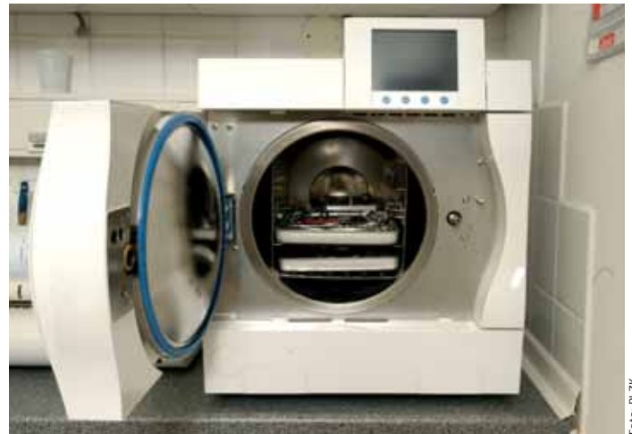
Medizinprodukte, die zur sterilen Anwendung am Patienten vorgesehen sind, werden in der Regel in Kleinststerilatoren aufbereitet.
